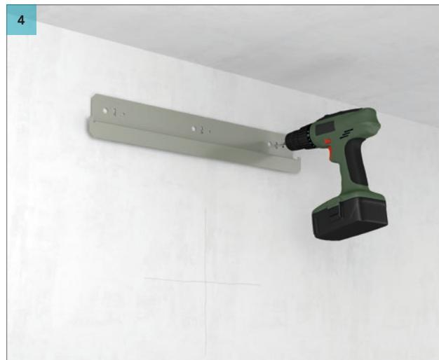
Просверлите отверстия и установите кронштейн для установки.
